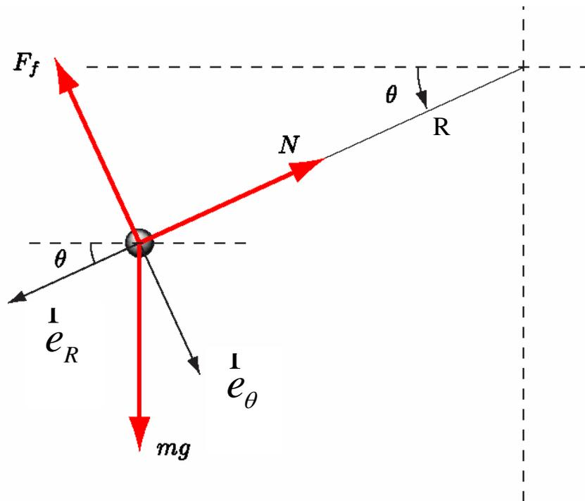
FIGURE 8 – FREE BODY DIAGRAM OF BEAD SLIDING ON A CIRCULAR TRACK
